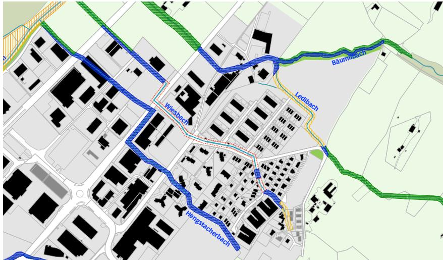
Abb. 8 Ausschnitt Wies- und Hengstacherbach: eingedolte Abschnitte, wo auf den Gewässerraum verzichtet wird, sind rot markiert. Im gelb markierten Abschnitt wurde der Gewässerraum gemäss Bachöffnungsprojekt definiert.
