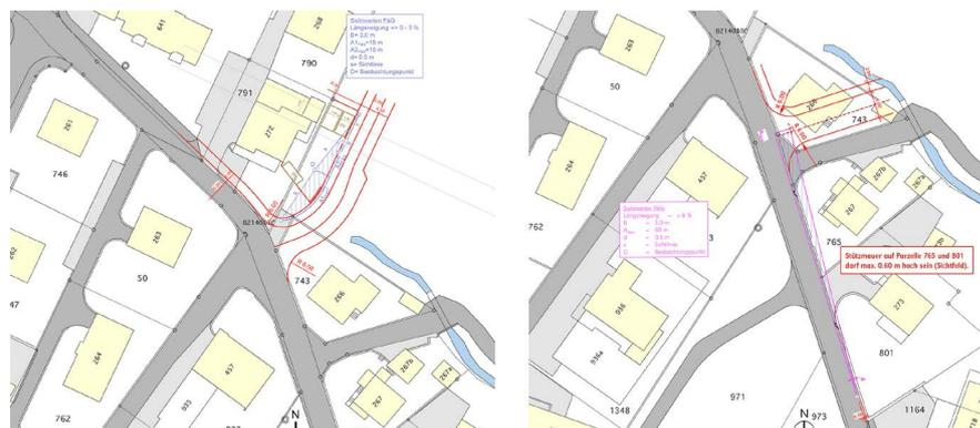
Abb. 59 Erschliessungsvarianten Wilmisberg: der künftige Anschluss muss zwischen diesen beiden «Maximalvarianten» zu liegen kommen (Quelle: teamverkehr, Zug)
